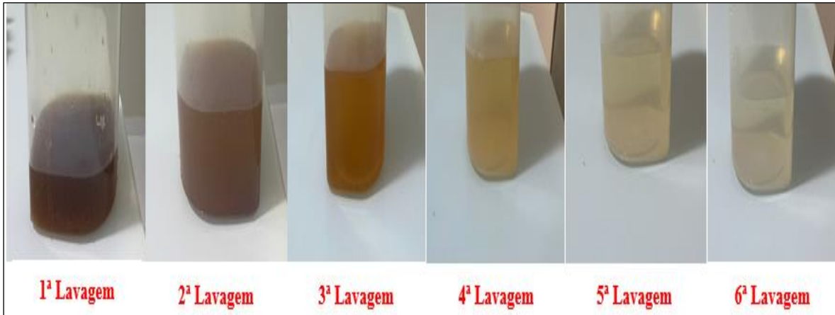
Figura 10: Água residual proveniente das lavagens do material.
